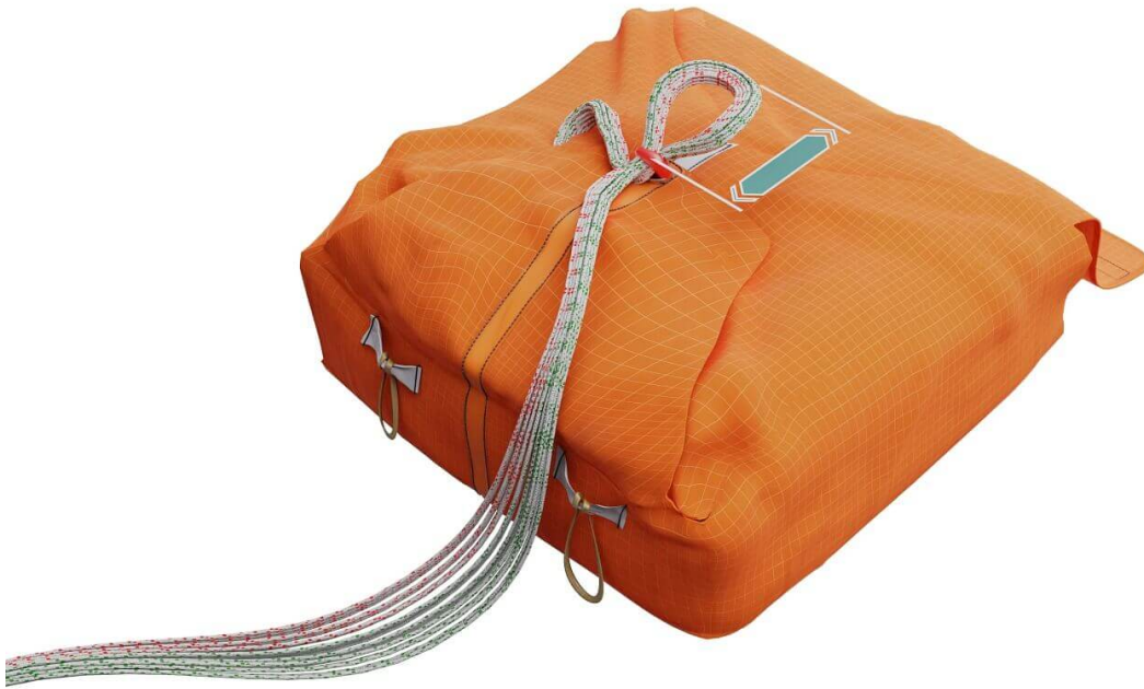
Fig. 47 Überprüfe die Länge der Leinenschlaufe, die das letzte Containerblatt verschliesst.
