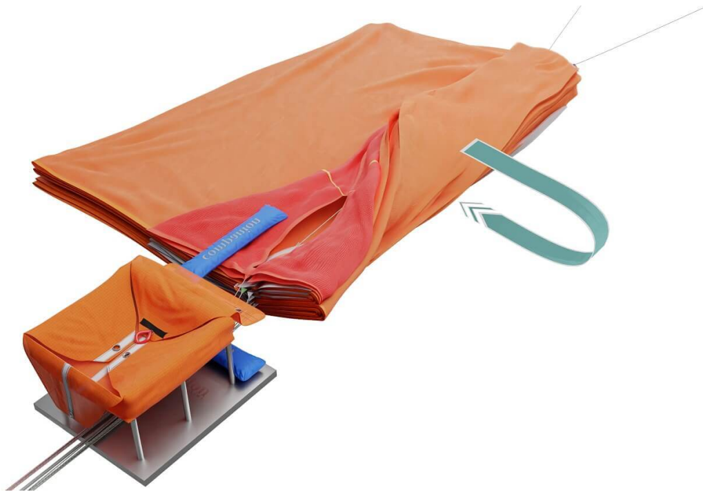
Fig. 37 Drehen des S-Schlags und anschliessendes Unterschieben.
