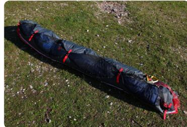
**Schritt 9** Drehe die Concerto auf die Seite und falte den Schirm zum ersten mal nach den Verstärkungen der Anströmkante. Falte nicht die Plastikverstärkungen. Falte den Schirm 1 oder 2 mal um die Anströmkante herum.
