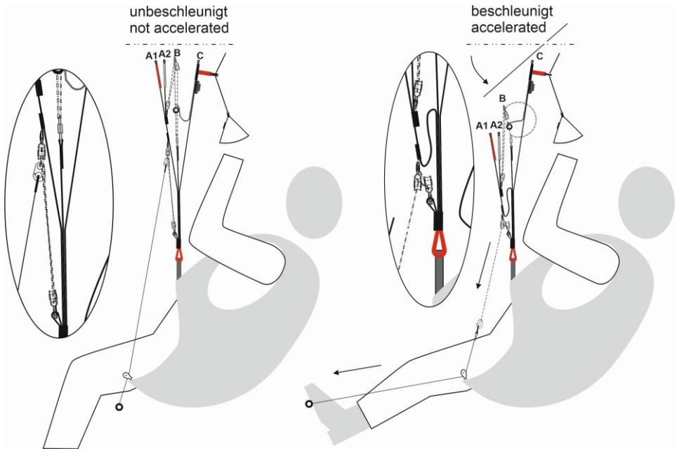
Abb. 4. Funktionsweise Fußbeschleuniger STELLAR RS
