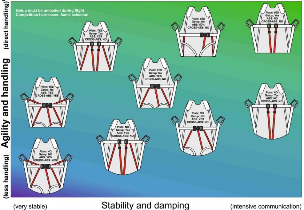
Abb. 6. Übersicht verschiedene Gurtzeuggeometrien und deren Dämpfung
