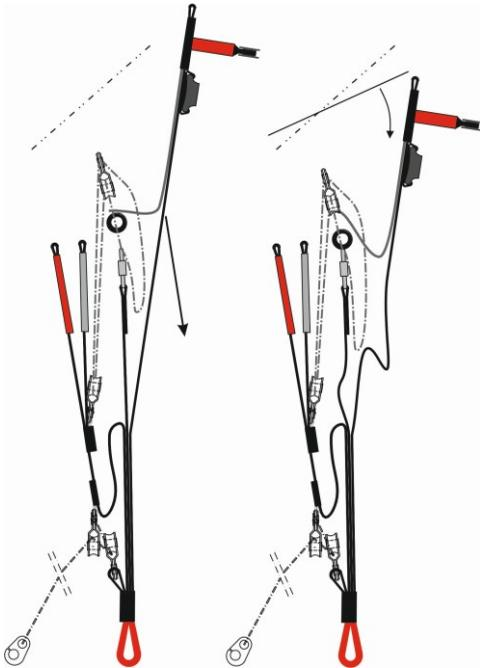
Abb. 5. Pitchkontrolle mit C-Bridge
